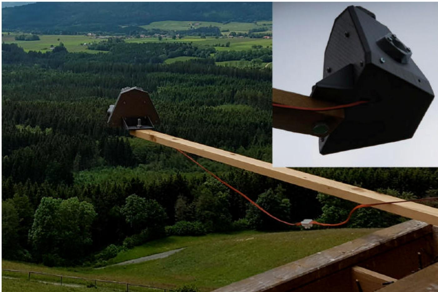
Das ist der erste Prototyp eines solchen rundum Überwachungssystems. Die Bilder der Kameras sind erstaunlich gut. Bei Tag werden alle 2 Sekunden 1 Bild gespeichert, bei Nacht wird ein Bild sechs Sekunden lang belichtet und dann gespeichert. Jeder Raspi (32GB) kann so für etwa 6-8 Wochen Daten und Bilder dokumentieren.
