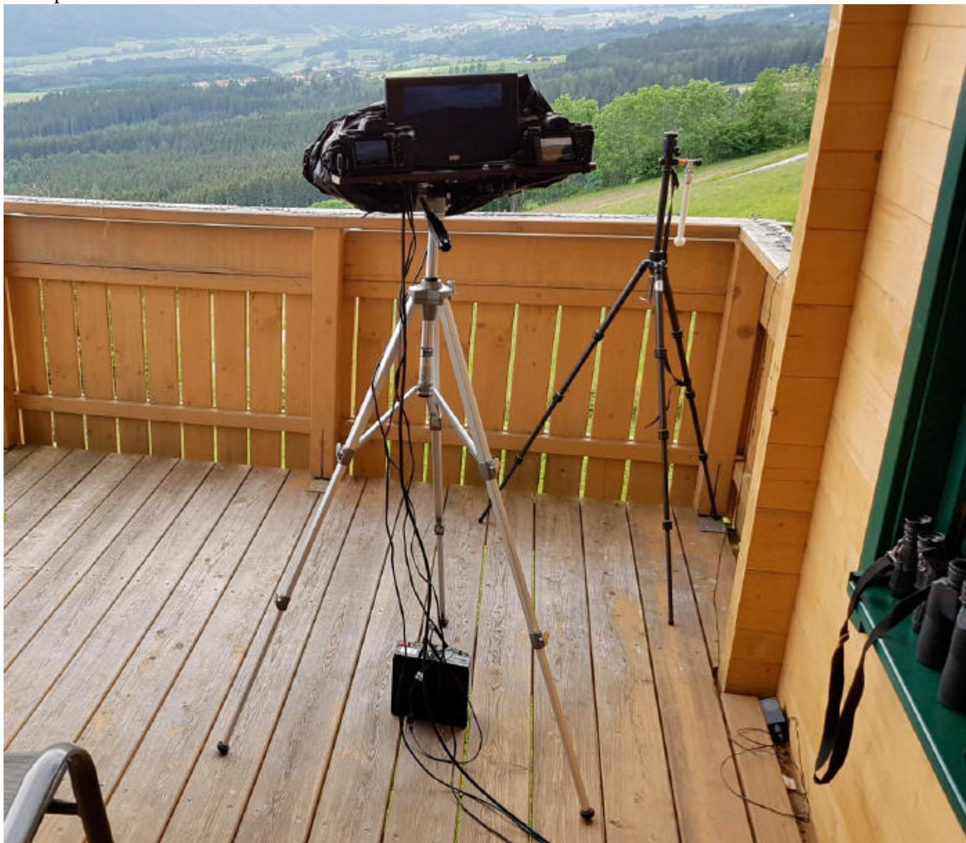
David hat eine neue Überwachungsstation die durch Akkubetrieb auch mobil eingesetzt werden kann. Hier wurde nicht gespart. Es sind zwei a7s und eine empfindliche Videokamera mit zusätzlichem Monitor eingebaut. Das System ist gedacht als Unterstützung und Dokumentation bei der Himmelsbeobachtung. Es ist zusätzlich auch zur autarken automatischen Überwachung geeignet.
