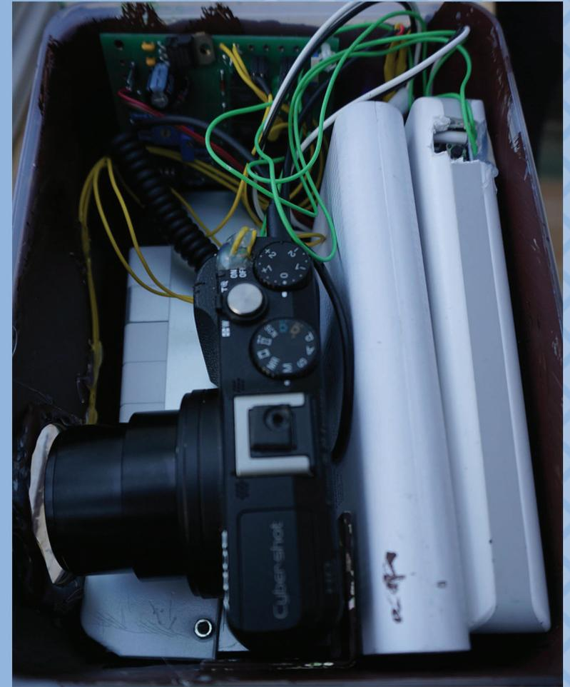
Nochmals der Funktionsablauf. Bei Dunkelheit schaltet sich die Steuerung ein und aktiviert die beiden Akkus für die Kamera. Dann wird die Kamera eingeschaltet und die Bildauslösung erfolgt über einen Kontakt der auf die USB Schnittstelle geschaltet wird. Dies wie bei einem handelsüblichen Kabel-Fernauslöser.
