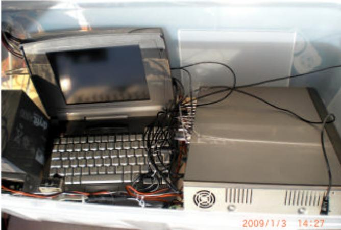
PC zur Messdatenaufnahme, Video-Alarmrecorder, Notstromversorgung, alles in einer wetterfesten Plastikbox.
