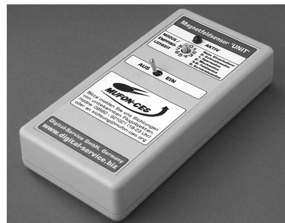
Einfacher, einachsiger Magnetfeldsensor (http://www.biz11.de/images/Dateien/a-Magnetfeldsensor-UNIT-Doku.pdf), basierend nicht auf Fluxgate-Spulen, sondern auf dem magnetoresistiven Effekt einer dünnen Struktur
