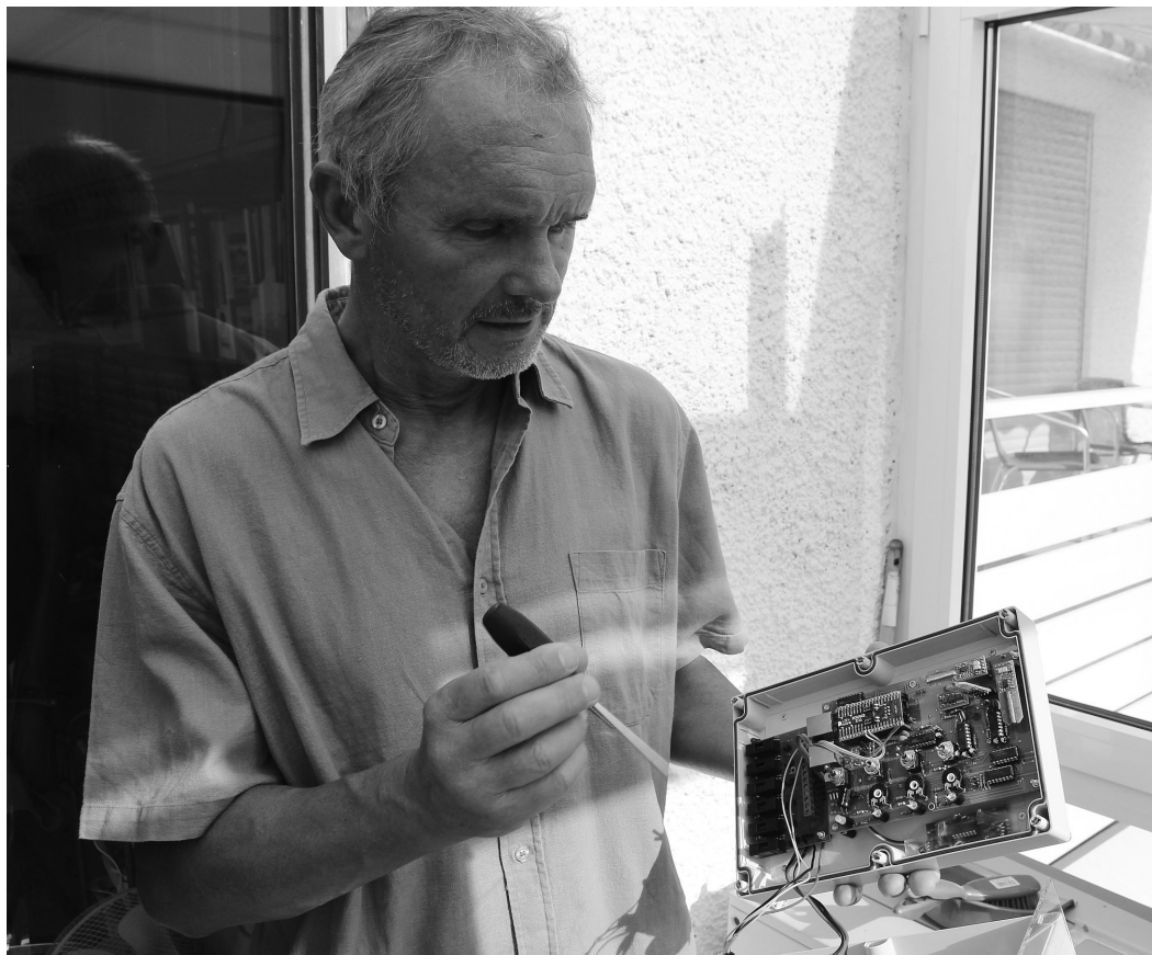
Gerhard Gröschel zeigt die Messplatine des Gravitations- und Magnetfeldsensors, oben rechts sind die drei Fluxgate-Spulen zu erkennen.
